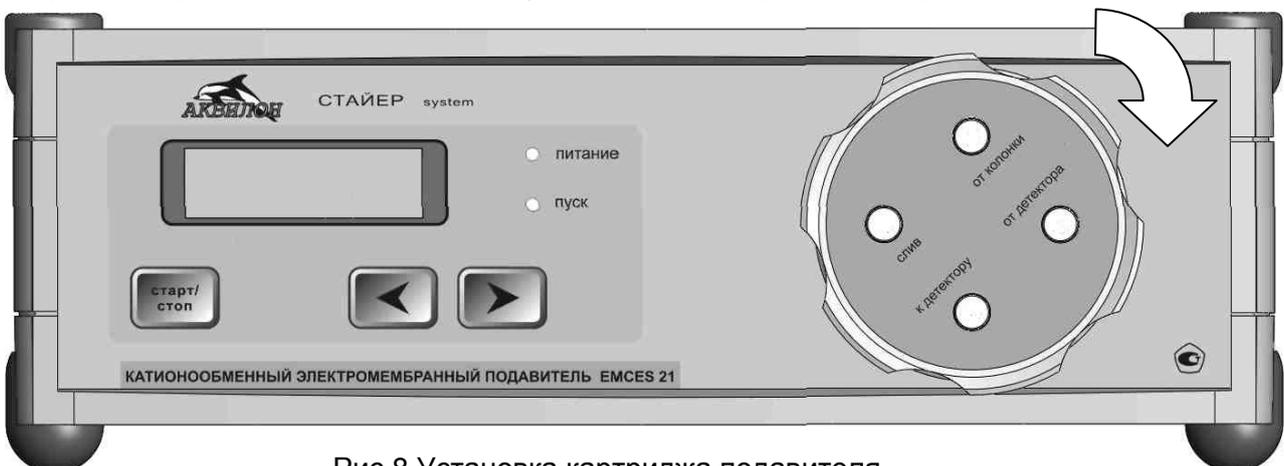
Рис.8 Установка картриджа подавителя
