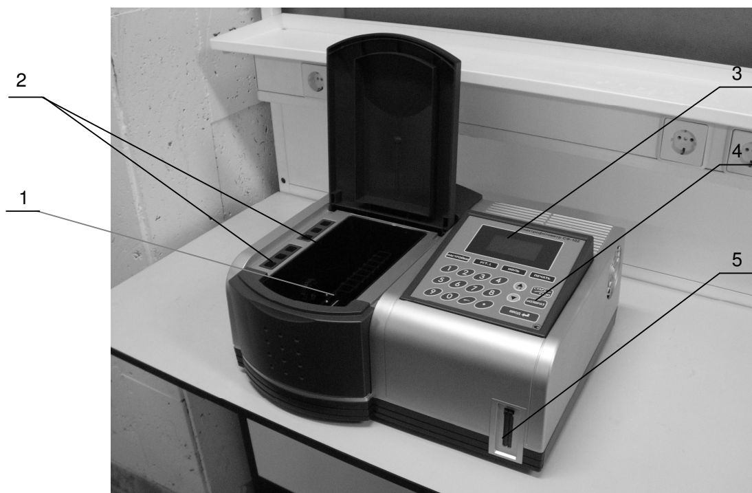
Рис. 2.2. Вид спектрофотометра СФ-102 спереди.
