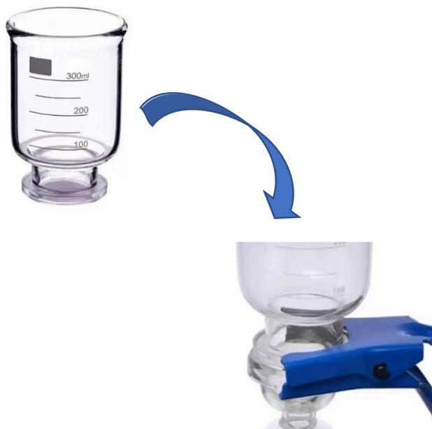
Для фильтрации подбирают соответствующий растворителю мембранный фильтр: гидрофильный или гидрофобный.
