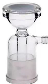
*Внимание! Шлифы должны быть сухими (излишек влаги можно удалить с помощью фильтровальной бумаги). В противном случае шлифовое соединение после работы под вакуумом будет сложно разъединить.*
